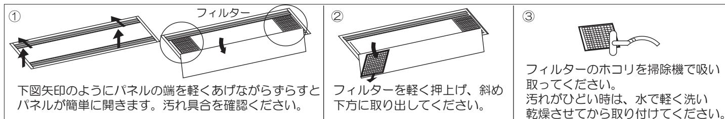
下図矢印のようにパネルの端を軽くあげながらすらすとパネルが簡単に開きます。汚れ具合を確認ください。
